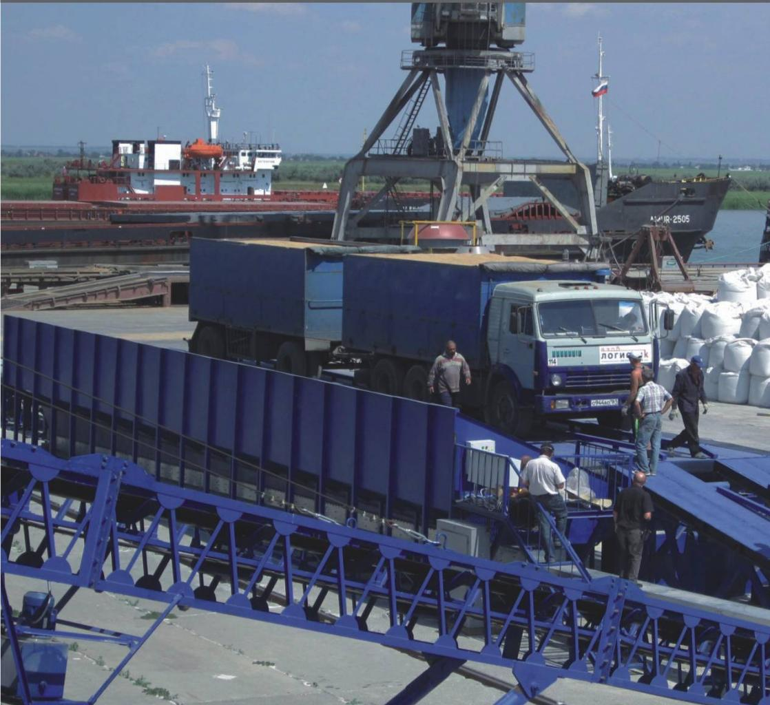
**Перегрузочный комплекс для навалочных грузов** – предназначен для приема зерна, продуктов его переработки, а также других сыпучих материалов из автотранспортных средств и автопоездов длиной до 24 м, и последующей перегрузкой в морской транспорт, склады напольного хранения, ж/д вагоны и т.д.
